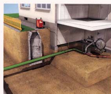
Nach dem Aushärten ist ein neues Rohr im Altrohr entstanden
